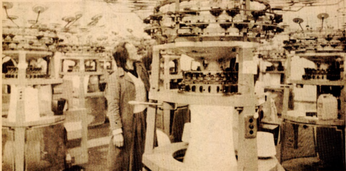
Pletionica: Savremeno kružno pletenje uz vrlo visoku produktivnost
