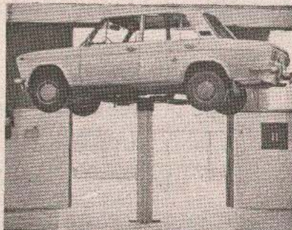
JEDNOSTUBNA PNEUMATSKA AUTO-DIZALICA DAI, NOSIVOST 15-25 kN
