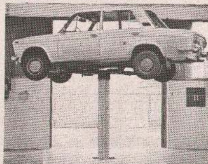
JEDNOSTUBNA PNEUMATSKA AUTO— DIZALICA DA1, NOSIVOST 15-25 kN
